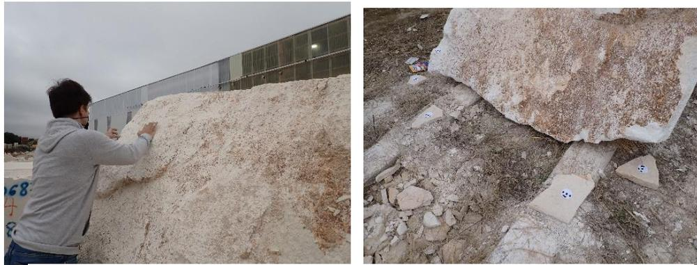
Figura 7. Colocación de las dianas sobre el bloque y los puntos exteriores de referencia.
