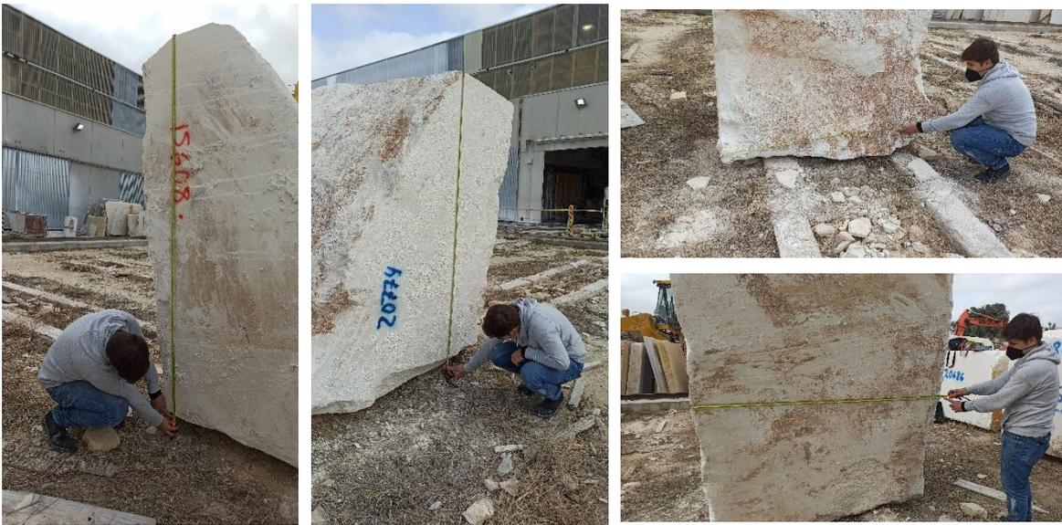
Figura 6. Medidas de las distintas caras del bloque de piedra caliza para realizar la nube de puntos.
