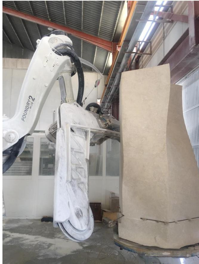
Figura 4. Máquina CNC con hilo de diamante.
