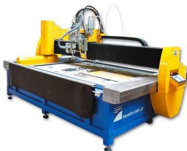
Figura 5. Máquina CNC de corte por chorro de agua. Fuente:
