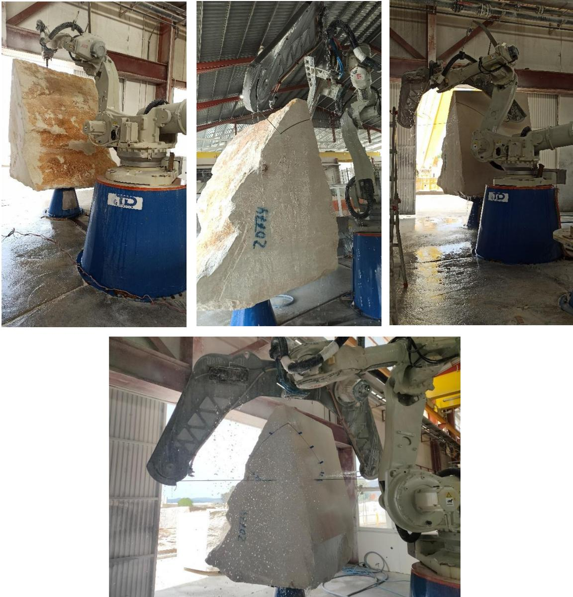
Figura 3. Proceso de moldeado 3D con la maquinaria CNC el primer día de fabricación del arrecife.
