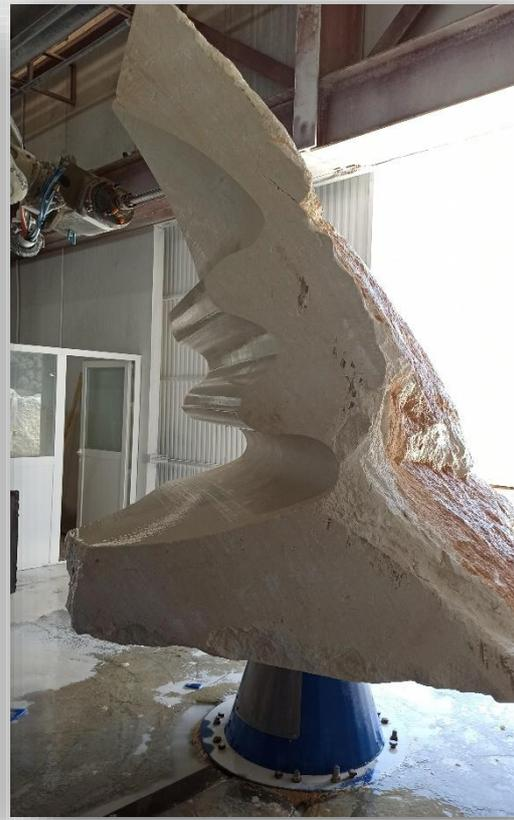
Figura 7. Arrecife artificial construido. Vista de los diferentes perfiles.
