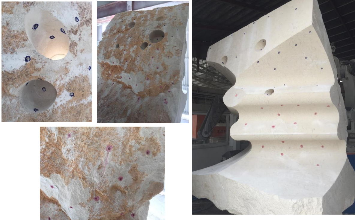
Figura 9. Agujeros practicados con broca por toda la superficie del arrecife artificial para insertar la placa de asentamiento con los corales, una vez esté fondeada la estructura.
