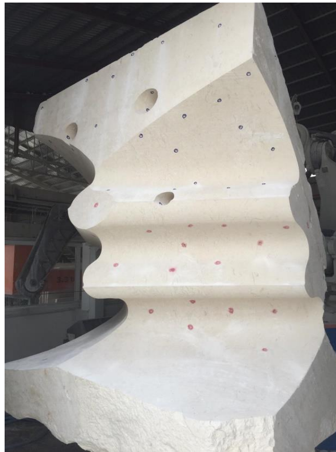
Figura 3. Arrecife artificial con agujeros para la inserción de las placas de pre-asetamiento con corales.
