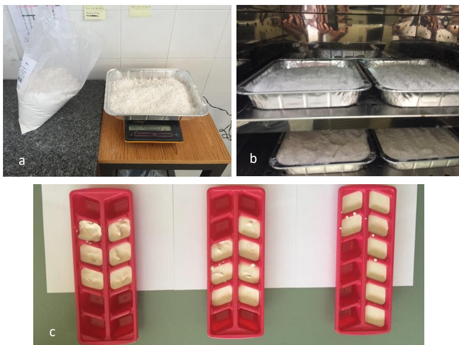
Figura 2. Pesado de la cantidad de yeso necesaria (a), pesado (b). Cubetas de PVC rellenas de la mezcla formada (c).
