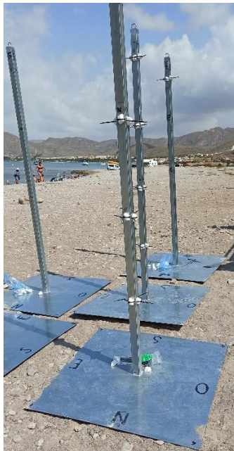
Figura 4. Estructuras verticales de acero inoxidable de 2m de altura, con marcas cada 0,5m en las que están colocadas, en orientaciones N, S, E y O, los clod cards.
