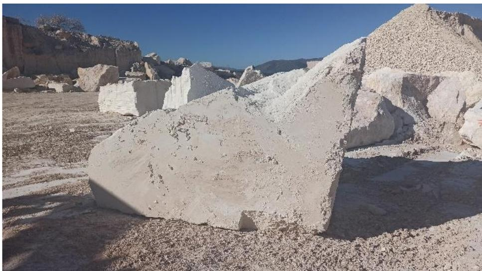
Figura 10. Bloque de roca caliza seleccionado para el proyecto.
