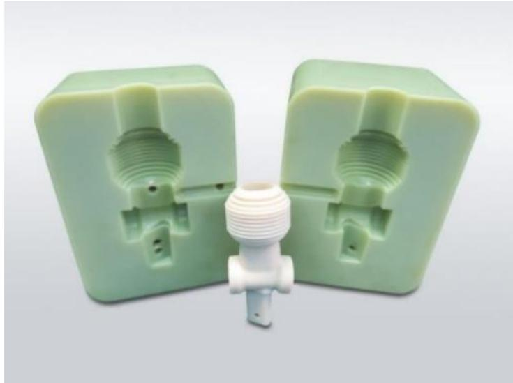
Figura 4. Moldes de inyección para la fabricación de piezas: Fuente: <https://impresiontresde.com/moldes-de-inyeccion-impresion-3d/>
