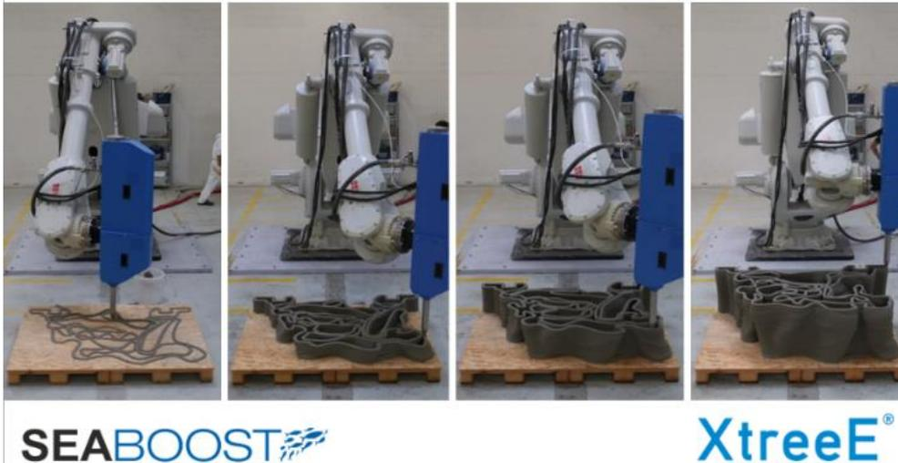
Figura 2. Fabricación 3D utilizando cemento depositado en capas para la construcción de un arrecife artificial.
