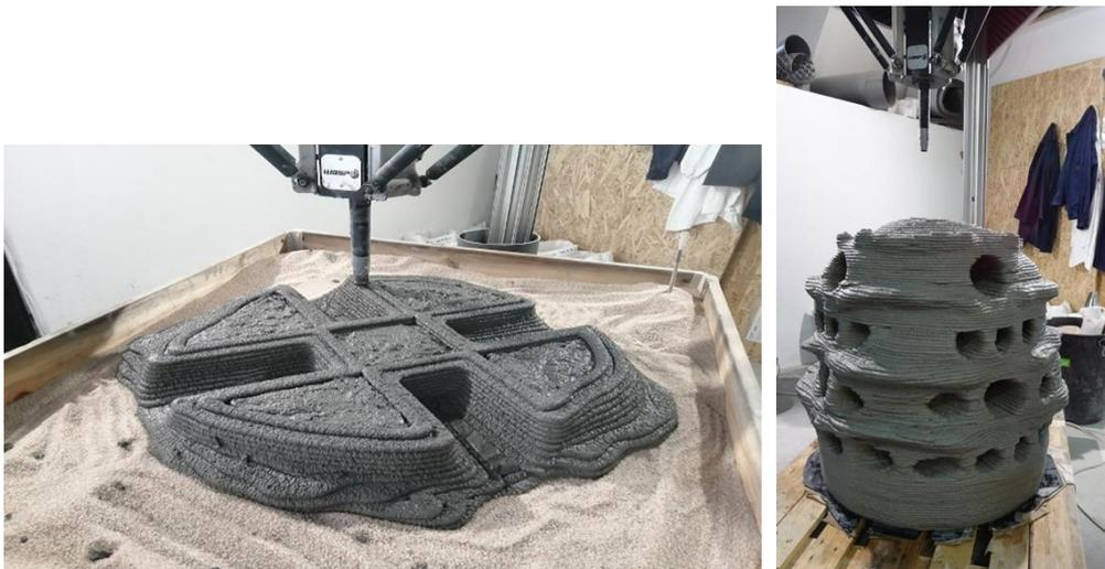
Figura 3. Proceso de elaboración de arrecife artificial con fabricación aditiva con impresión 3D del proyecto 3DPARE llevado a cabo por la Universidad de Cantabria (España). ©3DPARE. Fuente: <https://www.giteco.unican.es/proyectos/3dpare/index.html>
