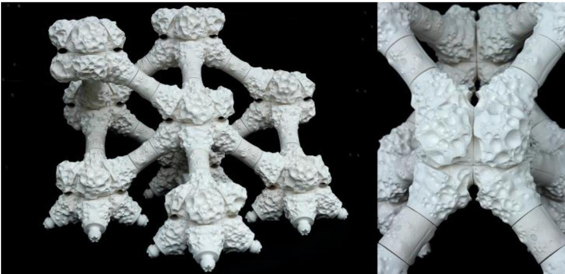
Figura 5. Arrecife modular creado mediante el uso de moldes elaborados con impresión 3D y relleno de cerámica.
